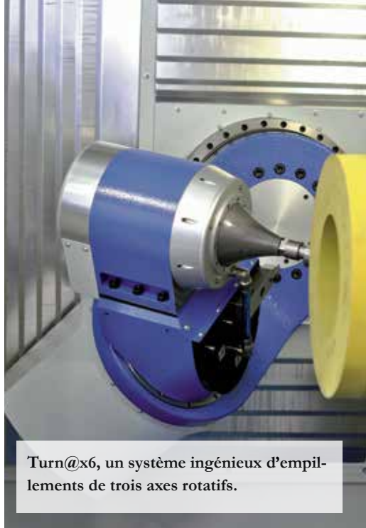
C-480, centre de rectification et de terminaison, 7 axes CNC dont 6 interpolables simultanément.
