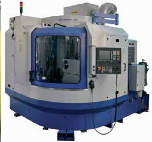
C-480, centre de rectification et de terminaison, 7 axes CNC dont 6 interpolables simultanément.
