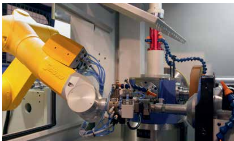
Dispositif de chargement automatisé de machine contenant un robot Staubli.
